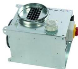
Ce ventilateur d'extraction sera équipé d'un pressostat d'alarme fonctionnant en tout ou rien permettant le report du signal de panne. Ce pressostat devra être monté en usine avec consigne de déclenchement prééglée à 80 Pa.
